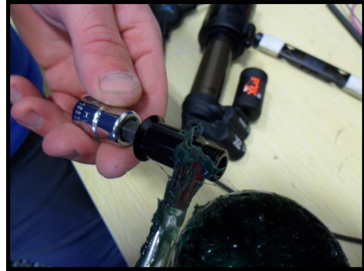
Step 4. Grease clevis shock bolt.
