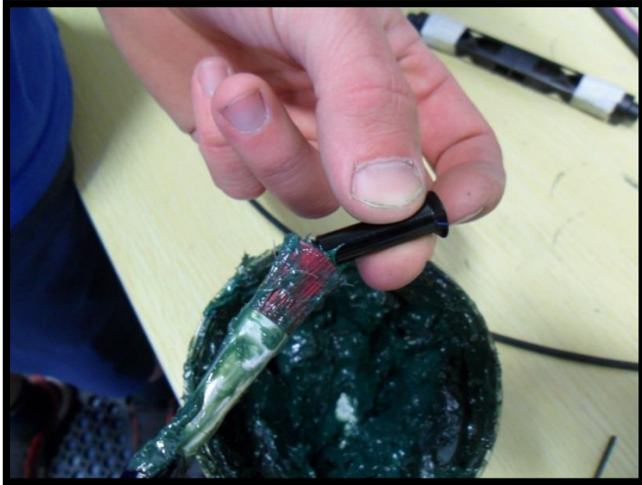
Step 3. Grease front shock bolt.
